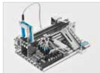
Nach einer kurzen Einführung ist es Aufgabe der Schülerinnen und Schüler, Aktoren und Sensoren so anzusteuern, dass die Prozesse in den Maschinenmodellen Transportband, Handling bzw. Stapelmagazin geordnet ablaufen. Ausgehend von einfachen elektrischen Schaltkreisen arbeiten sich die Kleingruppen dabei zu komplexeren pneumatischen Schaltkreisen vor, bei denen Sensoren die Systemzustände erfassen und Ventile und Motoren angesteuert werden.
